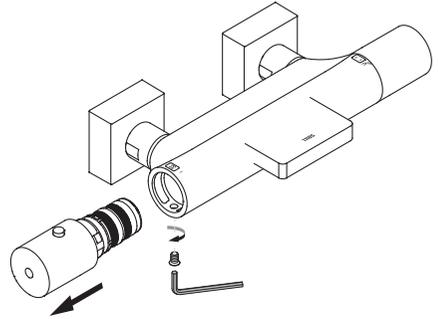
CALIBRADO DE TEMPERATURA • CALIBRAGE DE LA TEMPERATURE • TEMPERATURKALIBRIERUNG • KALIBREREN VAN DE TEMPERATUUR •
