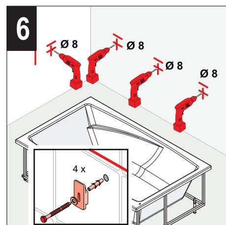
Przepisy dotyczące instalacji w odniesieniu do montażu wanny
