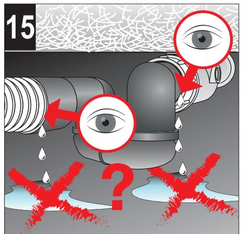
Przepisy dotyczące instalacji w odniesieniu do montażu wanny
