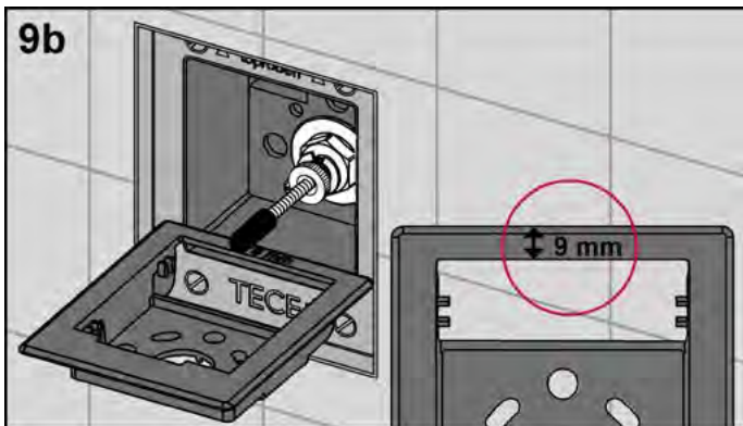
Dźwignię uruchamiającą wkręcić tak mocno, jak to zalecane (w przypadku zlicowanego TECEloop odstęp 9 mm od przedniej krawędzi wewnętrznej ramy montażowej) i zabezpieczyć przed przekręceniem za pomocą nakrętki zabezpieczającej.
