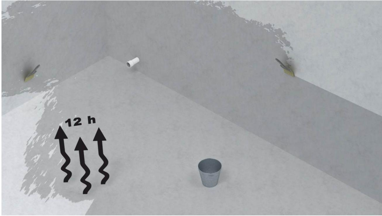
**UWAGA!** Powierzchnia montażowa powinna być czysta, równa, stabilna bez widocznych spękań.
