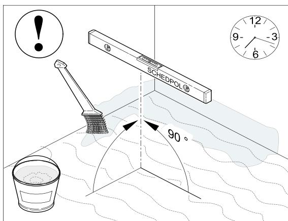
**UWAGA!** Powierzchnia montażowa powinna być czysta, równa, stabilna bez widocznych spękań.
