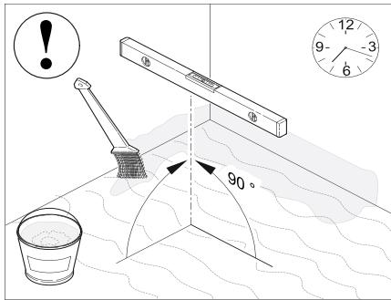
**UWAGA!** Powierzchnia montażowa powinna być czysta, równa, stabilna bez widocznych spekań.
