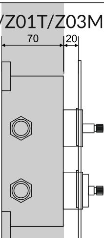
Poprawnie zamontowany box powinien być osadzony na głębokości uwzględniającej grubość płytkaściennych oraz warstwę kleju.
