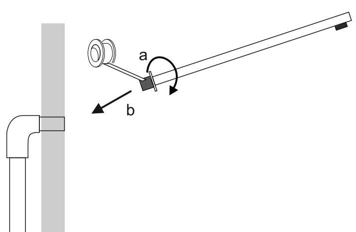
Gwintowany element ramienia należy uszczelnić taśmą teflonową i wkręcić w przygotowane przyłącze. Wyjście ramienia powinno znajdować się pionowo w dół.
