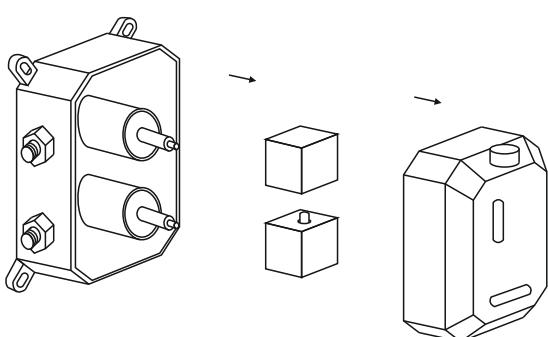
Po zakończeniu prac wykończeniowych należy ściągnąć plastikową osłonę oraz znajdujące się pod nią pokrętła aby założyć maskownicę.
