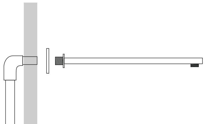
Do instalacji ramienia wymagane jest wcześniej przygotowane wyjście wody w ścianie o rozmiarze  $\frac{1}{2}$ ".
