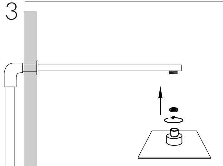
Deszczownicę wkręcamy w wyjście ramienia, umieszczając filtr siateczkowy.
