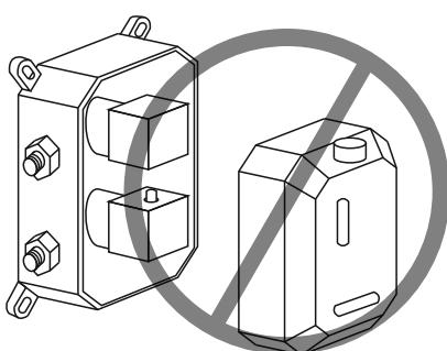
W celu uniknięcia uszkodzeń mechanicznych mogących wystąpić w trakcie prac wykończeniowych, nie należy ściągać plastikowej osłony z boxu.
