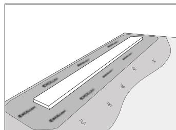
6. PL Na świeżo rozprowadzony klej nakleić elastyczny mankiet uszczelniający.
