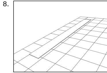
8. PL Po odczekaniu czasu zalecanego przez producenta folii w płynie, można przykleić wierzchnią warstwę (gres, terakota, granit itp.) Szczelinę pomiędzy ramką rynienki i powierzchnią podłogi należy wypełnić elastycznym silikonem sanitarnym kolorystycznie dopasowanym do koloru podłogi i fug.
