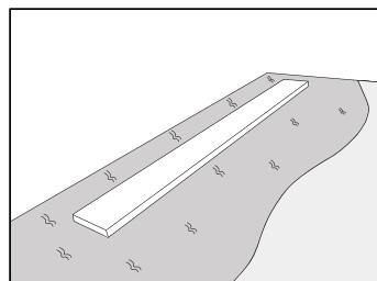
5. PL Powierzchnię kołnierza oraz otaczającą ją część posadzki pokryć folią w płynie.
