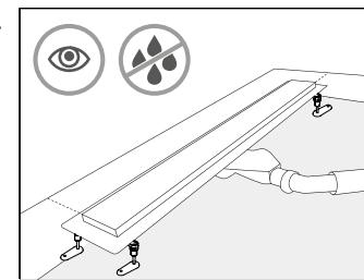
PL Rynienkę podłączyć do kanalizacji i ustawić tak, aby jej góra krawędź znajdowała się ok. 1 mm poniżej ustalonej powierzchni podłogi.
