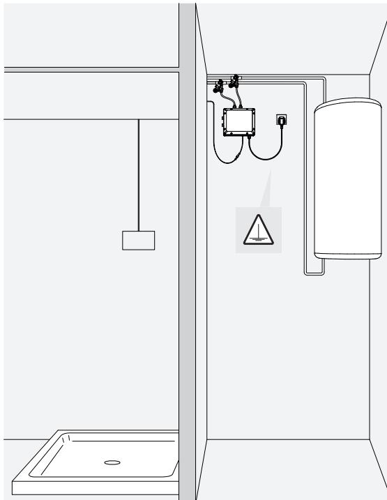
**es** La ilustración de instalación es orientativa. Colocar la caja de control en un lugar registrado y de fácil acceso que permita realizar con facilidad las tareas de mantenimiento.
